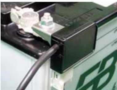
車載用鉛バッテリー状態検知センサー 取り付け状態図
